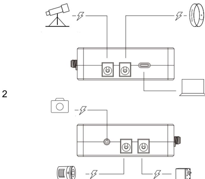
1.ASIAIR Mini 仅需要 12V@2A 电源就可以正常工作。但考虑到通过其 4 个 DC 输出口为其他设备供电，建议使用 12V@5A 的电源。
