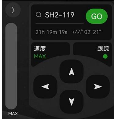
方向按钮和速度滑条：可以配合使用，选择不同的移动速率，从而移动赤道仪的赤经轴或赤纬轴，完成自己偏好的构图或其他需求。
