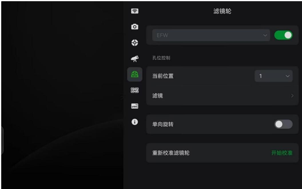
连接滤镜轮后，即可配置滤镜轮。
