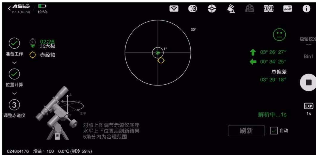
根据右侧绿色数字调节赤道仪的方位和俯仰角（调节前先松开赤道仪的方位缩死螺丝和俯仰角松紧器）。“√”勾选右下角的自动刷新，可在赤道调节过程中实时刷新赤道仪的偏差数值。
