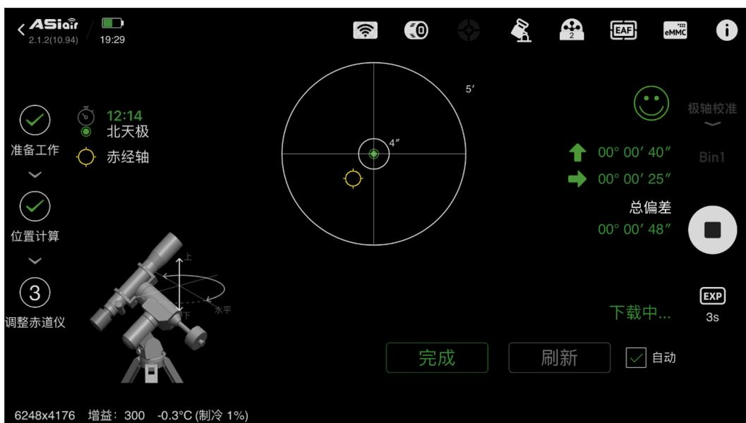
调节完毕后, 请及时锁死方位锁死螺丝和俯仰角松紧器。点击完成后, 获得排名数据。
