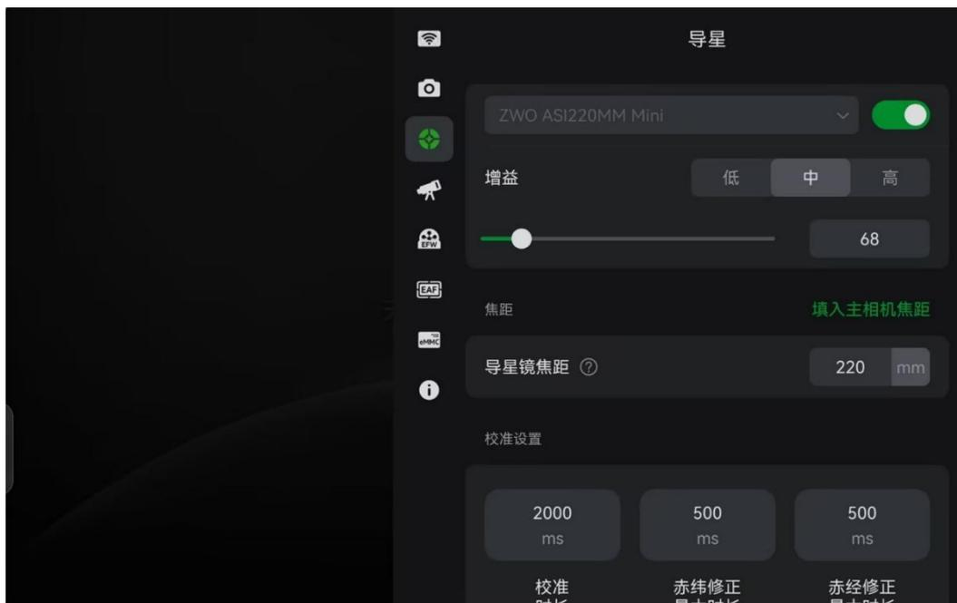
在这里选择并打开导星相机，推荐增益选“高”，主相机与导星相机的焦距请务必填写准确。
