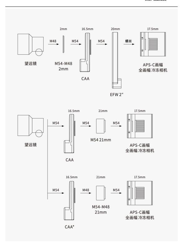
注释:标注"\*"的 CAA 需要将 M54 连接件替换成 M48 连接件(自带)。
