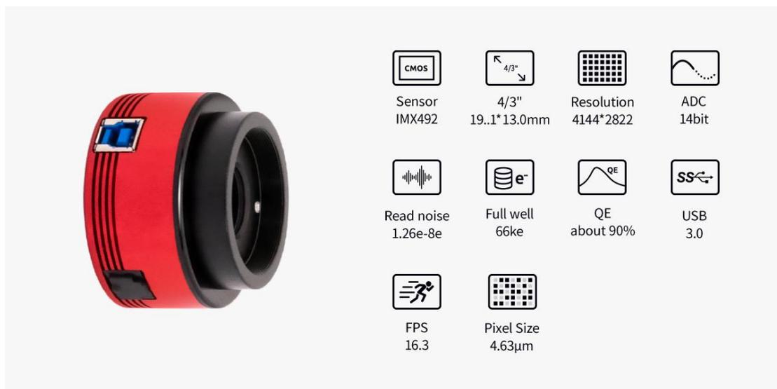
ASI294MM 是一款黑白背照式行星相机。相机采用 Sony IMX492 14bit ADC 传感器，4.6μm 像素尺寸，66ke 满阱电荷，1170 万总像素。相机拥有约 90% 的超高 QE 峰值，以及 1.2e 的超低读出噪声，是当前小画幅黑白天文相机的不二选择。
