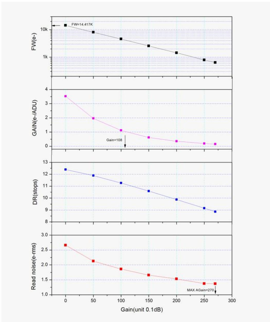
如您的望远镜与 2.3um 的像素大小搭配所得到的采样精度在合理范围内，则像素拆分模式会给您带来更多星体细节。然而在 Bin1 模式下，相机的 ADC 位数会由 14bit 下降到 12bit，动态范围也相应降低，文件大小大致为 Bin2 模式（相机默认模式）下的 4 倍。因此像素拆分模式有利有弊，需要您根据实际情况选择。
