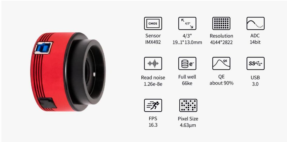
ASI294MM 是一款黑白背照式行星相机。相机采用 Sony IMX492 14bit ADC 传感器，4.6μm 像素尺寸，66ke 满井电荷，1170 万总像素。相机拥有约 90% 的超高 QE 峰值，以及 1.2e 的超低读出噪声，是当前小画幅黑白天文相机的不二选择。
