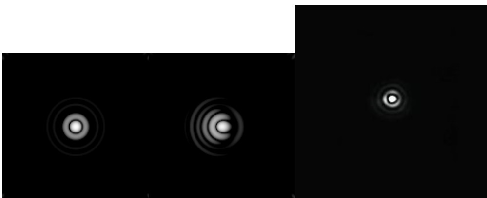
图 7 精确对焦得到的埃里图案（左一为光轴校准良好的图像，左二为校准效果不好的图像，左三为实际拍摄光轴校准良好的图像）
