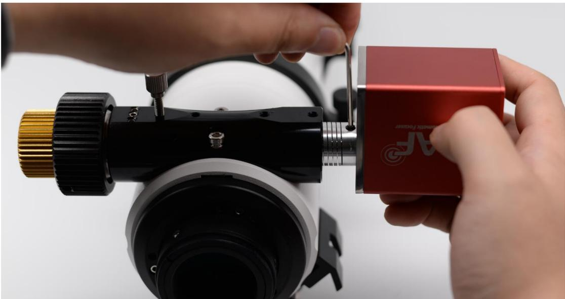
请注意在将轴承和顶丝连接时，需要将孔位对准轴承较平的一面，而非弧面，避免防止轴承被顶丝切割和磨损。
