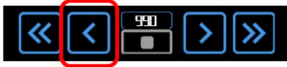
第三步，一次次点击向内移动的微调按钮，观察另一侧的调焦手轮，手轮开始转动说明已经走完回差。那么转动之前所点击的次数 $\times 10$ 就是回差的步数。
