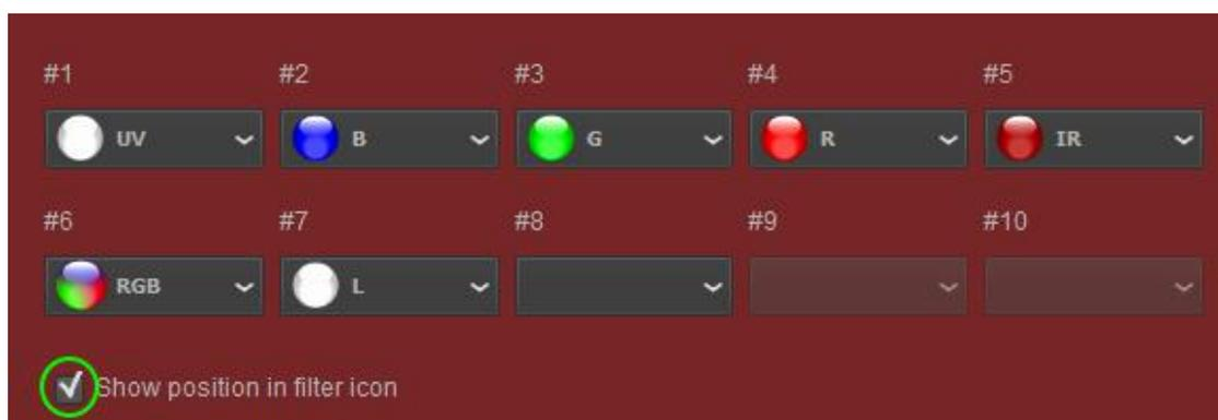
在“Capture”页里选择滤镜孔，转动过程中“Settings”里的滤镜轮图标会旋转
