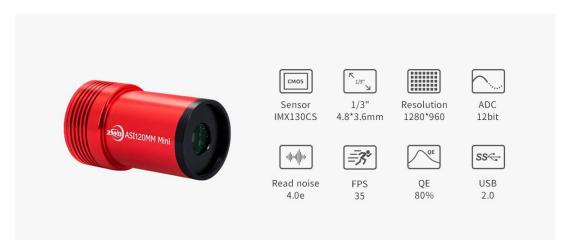
ASI120MM Mini 相机采用 ON AR0130CS 1/3 英寸感光芯片(4.8mmX3.6mm),是一款入门款导星相机。 它具有 1280X960 分辨率,像素大小为 3.75 $\mu$ mX3.75 $\mu$ m。采用 12 位 ADC,峰值量子效率接近 80%。
